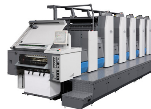
Fig. 12 - Máquina de impressão offset, sistema utilizado nos dias de hoje para impressão de grandes tiragens.
