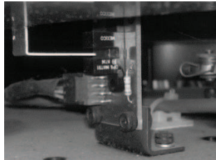
Figura 12 - Placa de leitura de posição de referência.
