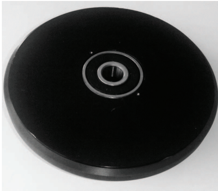
Figura 24 - Roda metálica com novo anel plástico.
