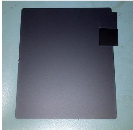
Figura 21 – Placa PUP pintada com duas pastilhas (fonte: KPP)
