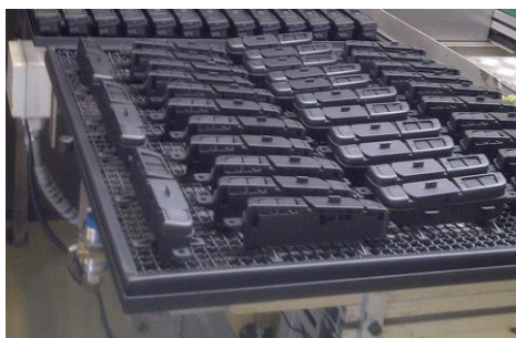
Figura 7 – Bastidor sobre uma palete colocado no tapete rolante (fonte: KPP)
