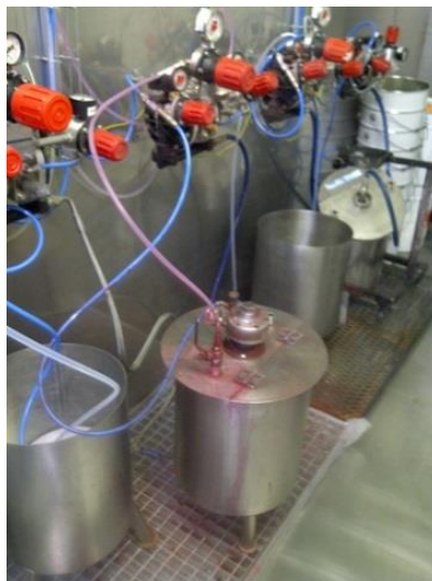
Figura 16 - Pote de tinta e bomba na Casa-das-tintas (fonte: KPP)
