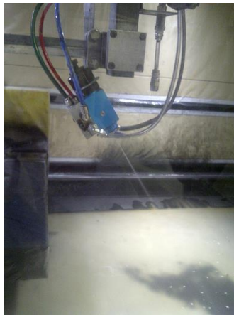
Figura 17 - Pistola em modo de limpeza (fonte: KPP)
