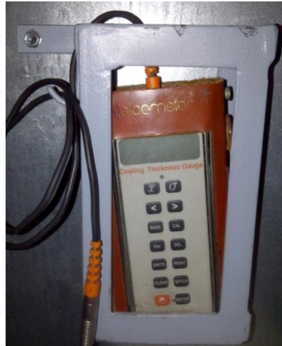
Figura 19 – Equipamento medidor de espessura (fonte: KPP)
