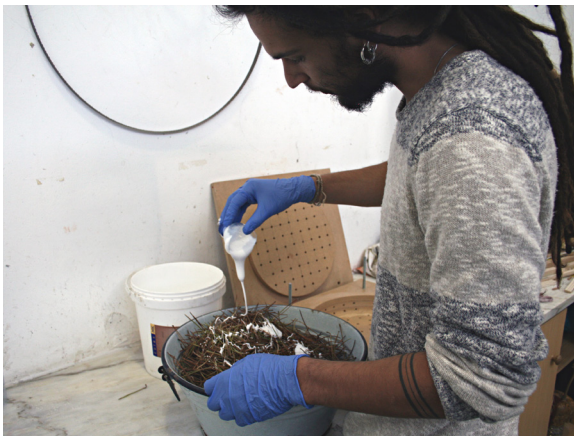
Fig. 41 Mistura da cola com caruma.
