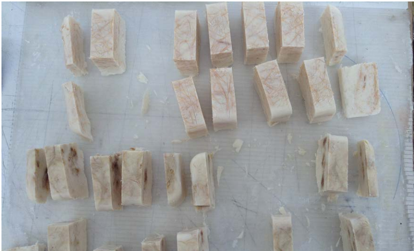
Fig. 172 Processo de corte: resultado bem conseguido.
