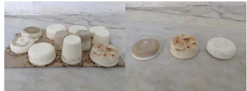
Fig. 160 e 161 Resultados da primeira experiência. Cargas utilizadas: areia, serradura e aparas de esfregão de cozinha.
