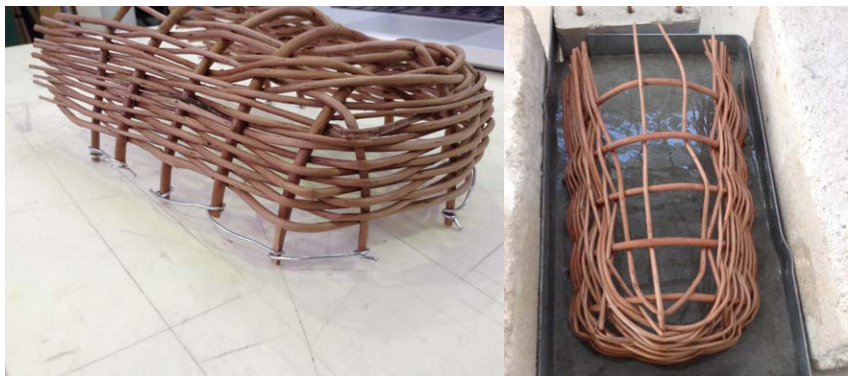
Fig. 73 e 74 Abrigo para aranhas: teste de ligação de vime e cimento | 2014
