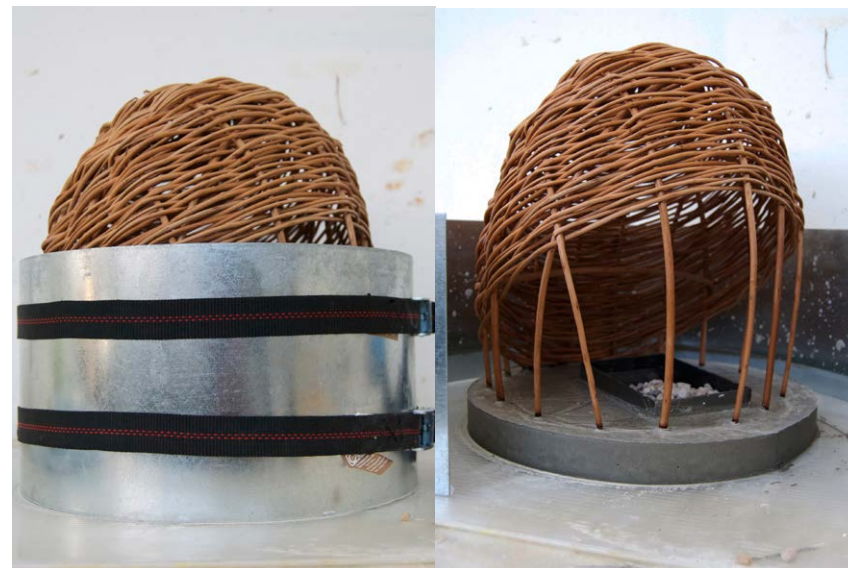
Fig. 99 Gaiola V: molde para colocação do cimento | 2015
