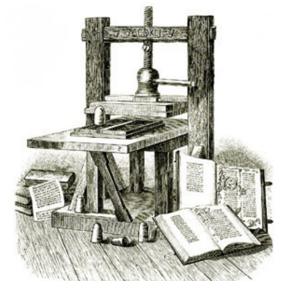
Fig.12 Prensa vinícola em madeira de Johannes Gutenberg, com caracteres de chumbo móveis - permitiu a reprodução de milhares de livros, iniciando-se a era do jornal moderno.
