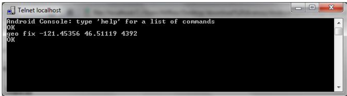
Figura nº. 49 – Ligação Telnet para testar o envio das coordenadas GPS
