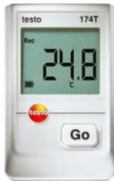
**Figura 2** Exemplo de *datalogger* com ecrã
