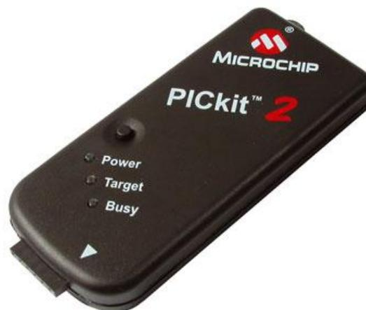
**Figura 40** Programador *PICKit 2* idêntico ao utilizado
