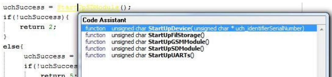
Figura 37 Captura de ecrã do assistente de código do *mikroC PRO for PIC*
