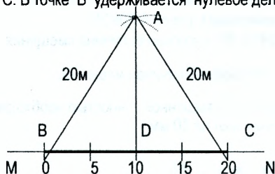
Рис. 29.5. Построение прямого угла при помощи рулетки
