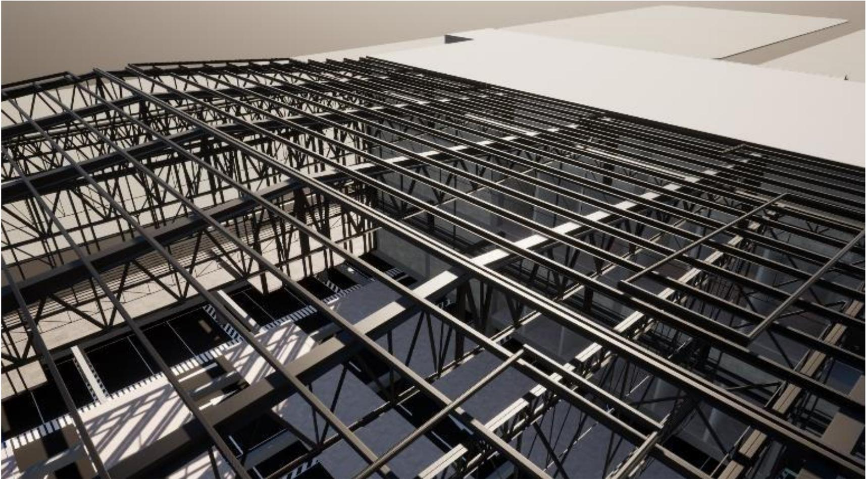
*Nota.* Vista 3D de la estructura metálica que va a sostener el techo del mercado desde arriba. Elaboración propia
