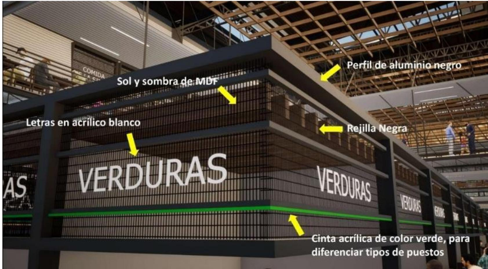
*Nota.* Vista 3D donde se aprecia el detalle de la parte superior de los puestos, el cual es una rejilla negra mate, con cinta de color para diferenciarse de otros puestos y con letras acrílicas blancas. Elaboración propia
