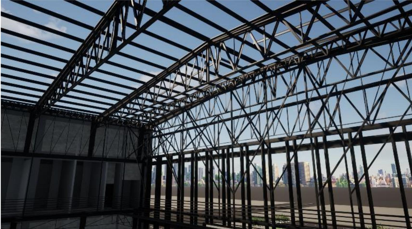
*Nota.* Vista 3D de la estructura metálica que va a sostener el techo del mercado desde abajo. Elaboración propia
