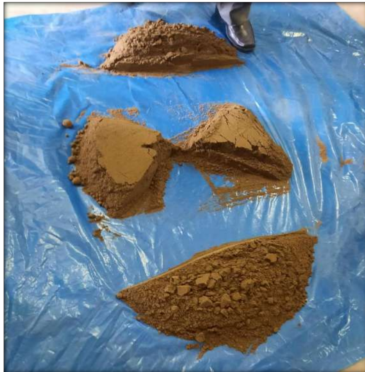
Fotografía 4. Procedimiento de selección de material necesario para ensayos del Agregado Fino (Cuarteo)
