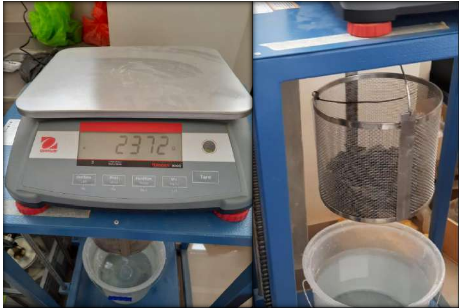
Fotografía 20. Peso específico, previamente se realizó la saturación de muestra (24 horas), peso de muestra antes de sumergir al balde con agua.
