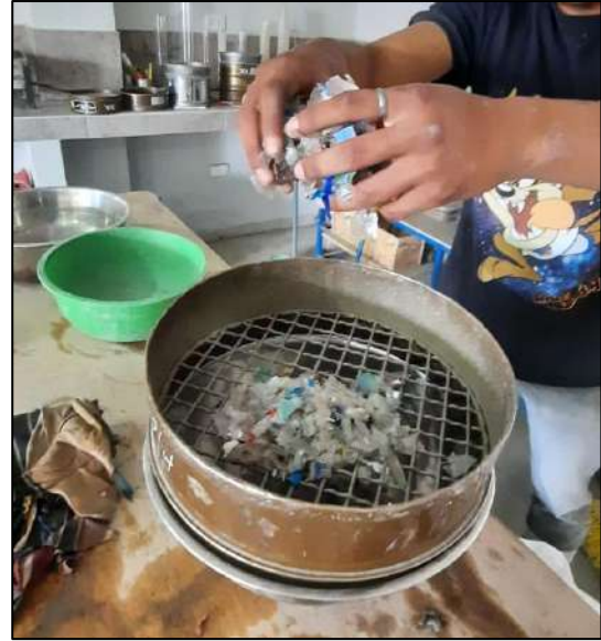
Fotografía 22. Análisis granulométrico del plástico reciclado del tamaño de 1/2"
