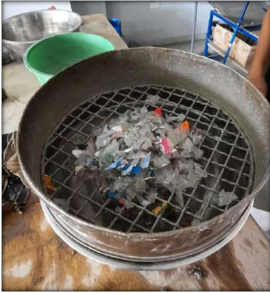
Fotografía 22. Análisis granulométrico del plástico reciclado del tamaño de 1/2"
