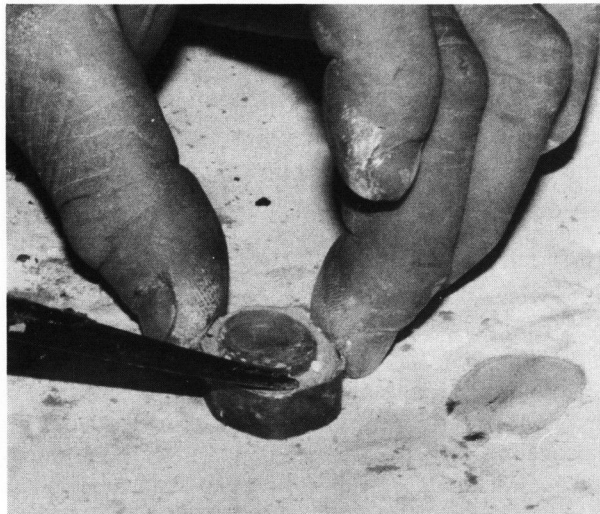
Bild 10. Andrücken des losen Tripelpulvers.
