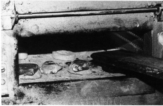
Bild 7. Eindrücken des weichen Glases in vier Formen.
