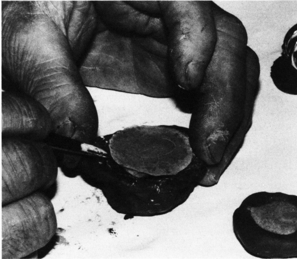
Bild 4. Abheben der trockenen Gips-Tripel-Form.
