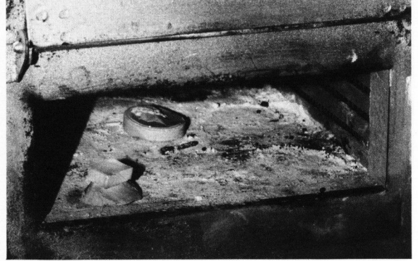
Bild 6. Glasstück auf der Form im Ofen.
