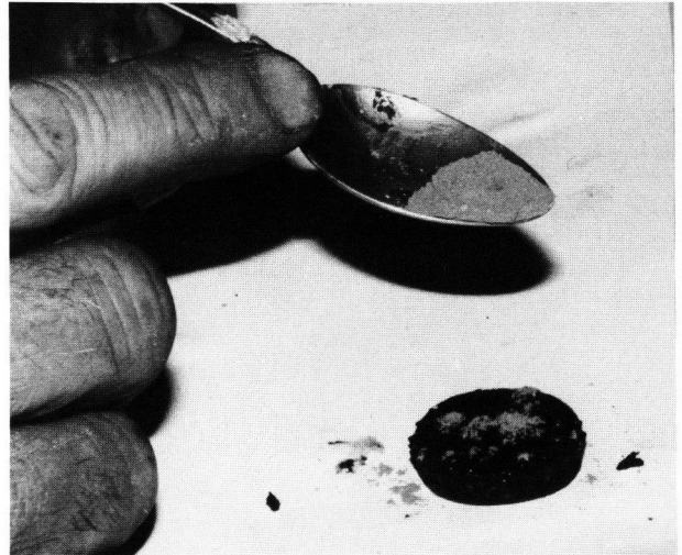
Bild 8. Aufstreuen von Tripelpulver auf den Tripelteig.
