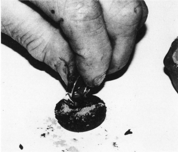
Bild 9. Eindrücken der Gemme in die Formmasse aus Tripel.
