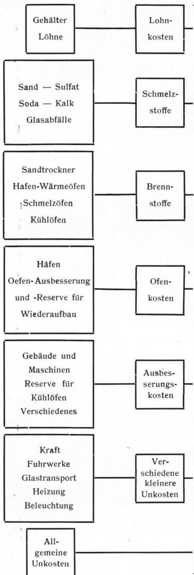
Bild 2. Zusammensetzung der Rohglasselbstkosten.
