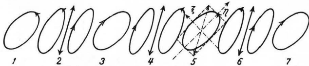
Bild 5. Polarisationszustand eines linear polarisierten Lichtbündels nach dem Durchgang durch eine elastische Transversalwelle.
