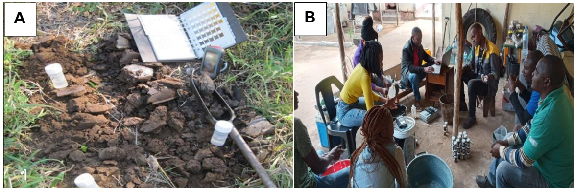
Figura 2: (A) Sondagem e recolha de amostras para a determinação do PH- H_2O , CE, (B) amostras perfiladas em ordem de leitura.
