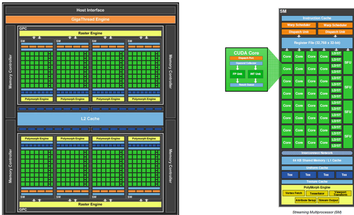
Figura i.3. Arquitectura de una tarjeta gráfica CUDA-enabled.
