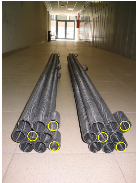
Fotografía 6-9. Módulos machihembrados terminados
