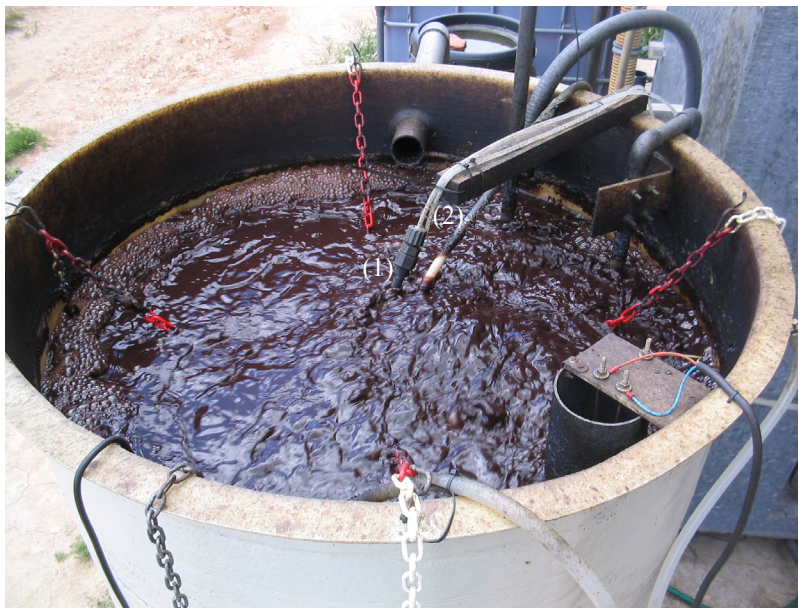
Fotografía 8-3. Detalle del MBR en funcionamiento
