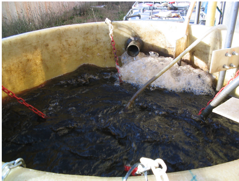
Fotografía 9-1. Agitación del MBR mediante bomba sumergida
