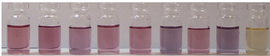
Figura 5. Disoluciones de compuesto (5) en DMSO con adición, de izquierda a derecha, de: nada, \text{CH}_3\text{SO}_3^- , \text{CH}_2\text{ClCO}_2^- , \text{CH}_3(\text{C}_6\text{H}_4)\text{SO}_3^- , \text{C}_2\text{O}_4^{2-} , \text{CH}_3\text{CO}_2^- , \text{F}_3\text{CCO}_2^- , \text{C}_6\text{H}_5\text{CO}_2^- y \text{NaCN}^- .
