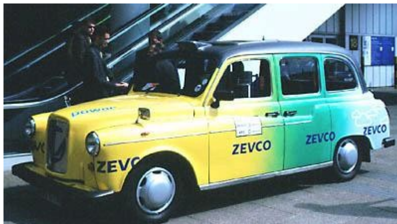
Figura 2: Taxi de Londres (Zevco) que utiliza AFC como fuente de propulsión.
