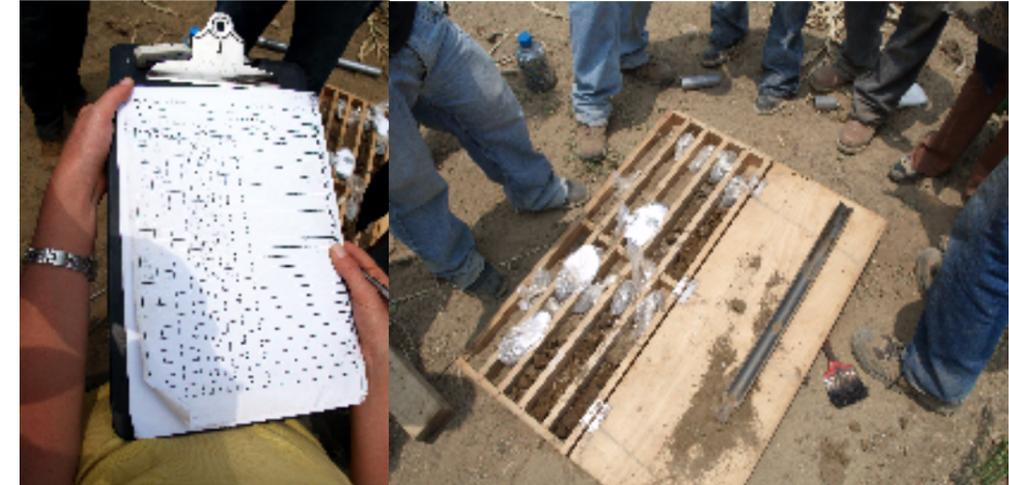
5. Hecho lo anterior, se saca el penetrómetro muestrador y se extrae el material recogido en su interior para hacer una inspección visual del suelo. Colocar en el muestrador de madera para hacer los análisis correspondientes.
