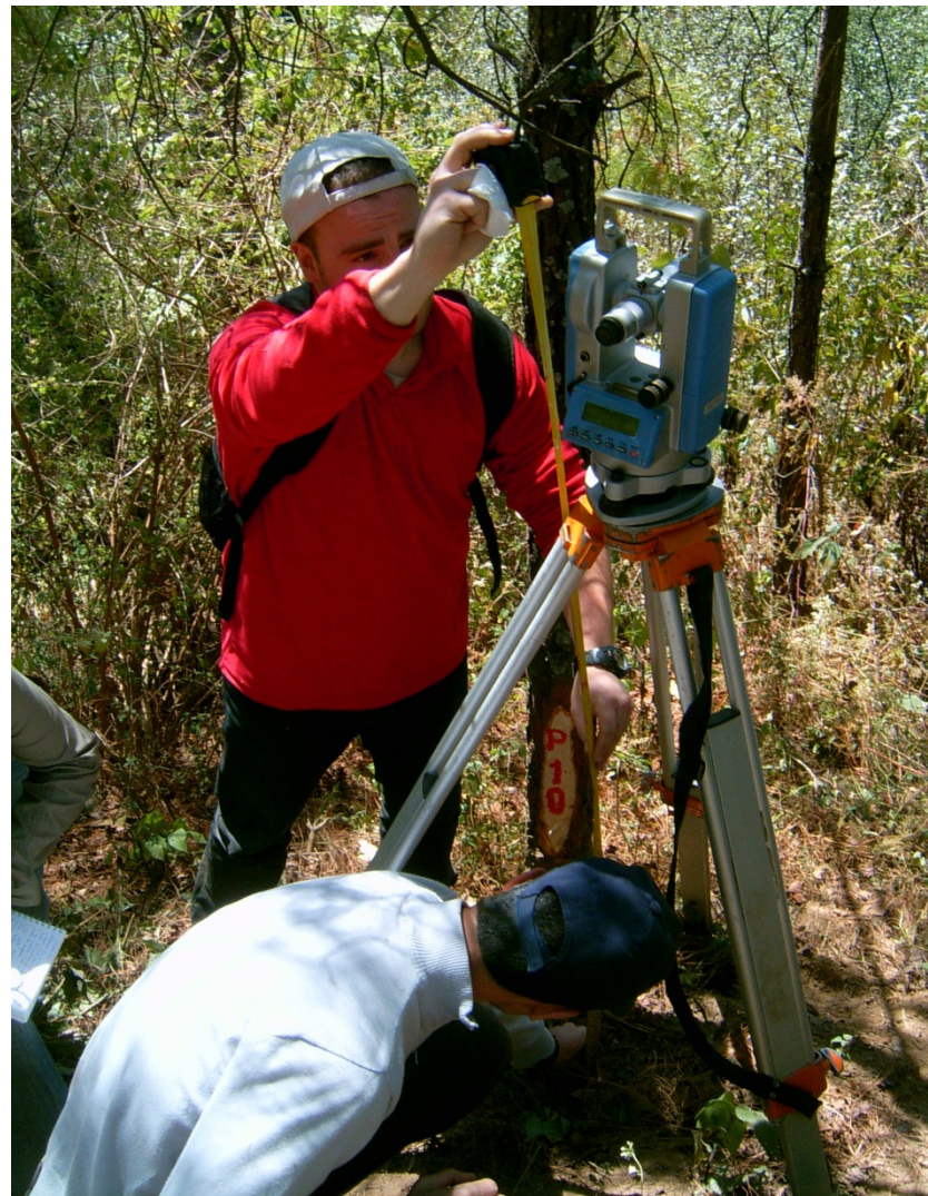
Figura 1.- Medición de la altura del aparato
