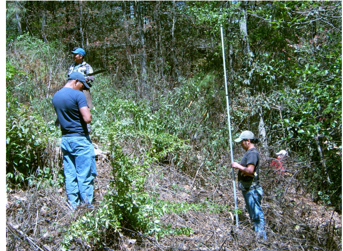
Figura2.- Levantamiento topográfico con estadal
