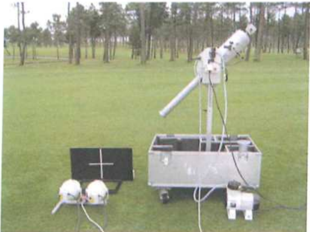
Figura 2. 1. Cañón utilizado para medir bote angulado sobre pavimentos de golf.
