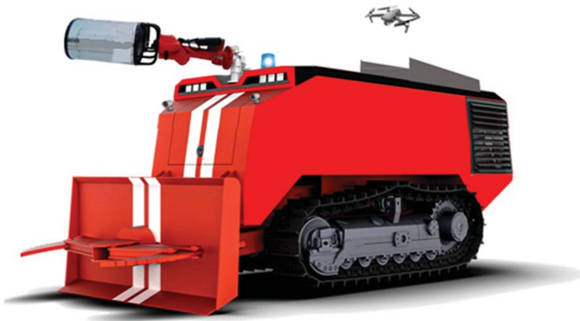
Рис. 1. Многофункциональный робототехнический комплекс пожаротушения тяжелого класса
