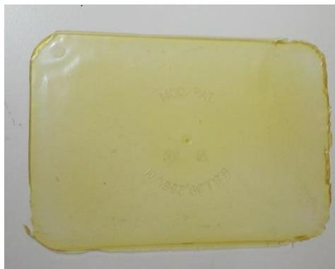
Figura 2.4. Filme à base de proteína isolada do tremçoço obtido experimentalmente.
