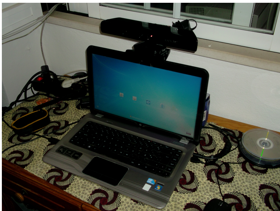
Figura 22: Cenário em que mostra como posicionar a Kinect por cima do monitor de um computador portátil.
