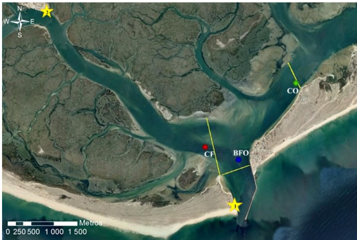
Figura 2.1- Localização dos pontos e secções de amostragem na barra de Faro-Olhão. As linhas a amarelo representam os transectos selecionados para a amostragem das velocidades e os pontos representam os locais da amostragem para análise química e medição de propriedades físico-químicas para as diferentes zonas: Barra Faro-Olhão (BFO), Canal de Faro (CF) e Canal de Olhão (CO), os PT's (as estrelas amarelas com o número no interior, 1- PT 1 perto de BFO, cais da ilha Deserta e 2- PT 2 no cais comercial de Faro, a 6 km a montante de BFO).
