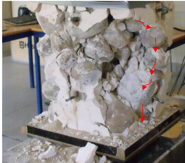
Figura 5.29 - Reajustamento antes de entrar em colapso.
