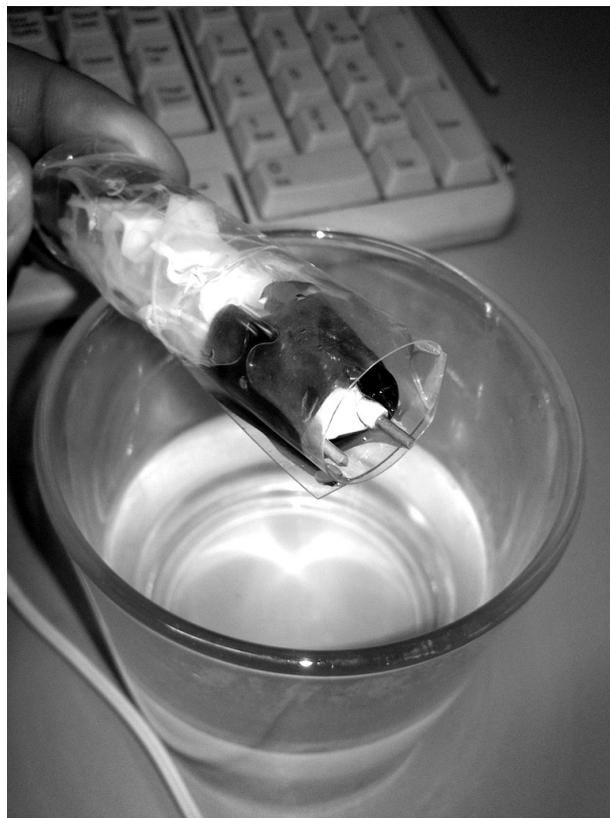
**Figura 3.12** - Sonda de concentração, pormenor da protecção plástica.
