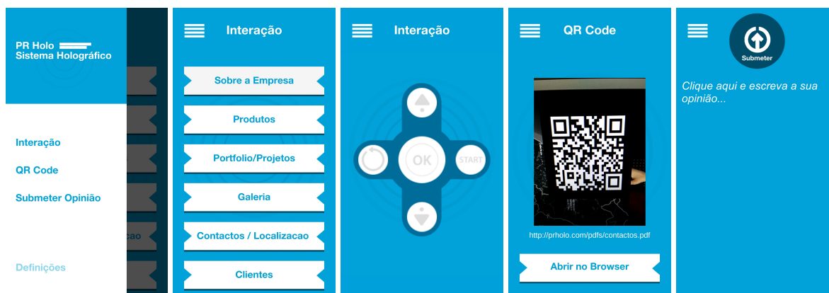
Figura 4.12: A aplicação Android. Da esquerda para a direita, o menu lateral da aplicação, seleção dos menus da instalação holográfica, seleção dos menus em forma de comando, leitor de códigos QR e submissão de opiniões.
