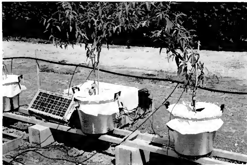
Foto 2 - Vasos cobertos com plástico branco para limitar a evaporação
