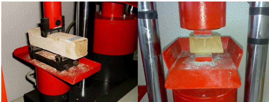
Figura 10: Ensaio de tracção por flexão (à esquerda) e ensaio de compressão (à direita)
