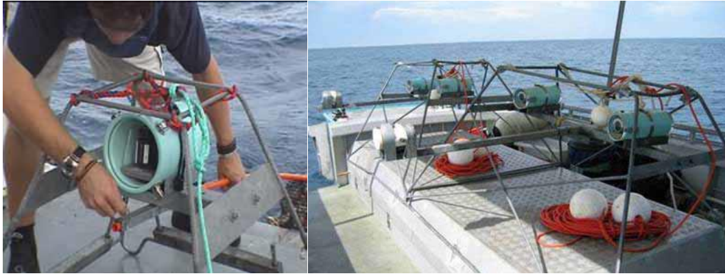
Figura 1.2: Exemplos reais de SVSIs: Com apenas uma camara (à esquerda) e stereo (à direita), usados nas águas Australianas (Cappo et al. , 2006).
