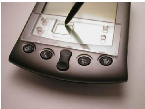
Figura 2.13 - Área de desenho de caracteres recortada dentro do molde
