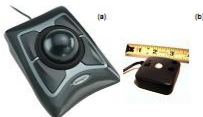
Figura 2.5 - Duas trackballs existentes no mercado. a) Trackball Kensington Expert Mouse, uma das maiores e mais populares. b) Trackball Appoint Thumbelina, uma das mais pequenas trackballs já fabricada.
