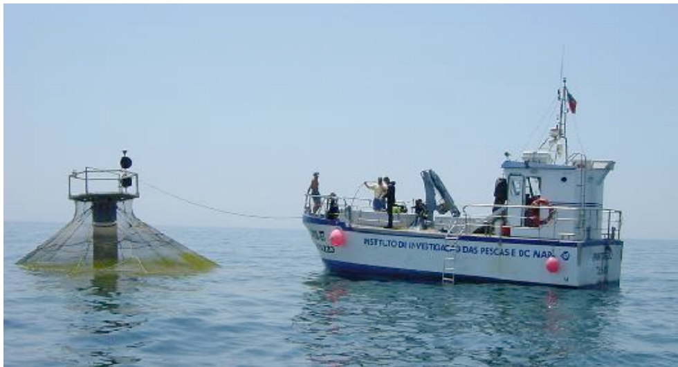
Figura 32: Embarcação “Puntazzo” usada pelo IPIMAR para operar as jaulas Sea Station (Fonte: IPIMAR, Pousão-Ferreira)
