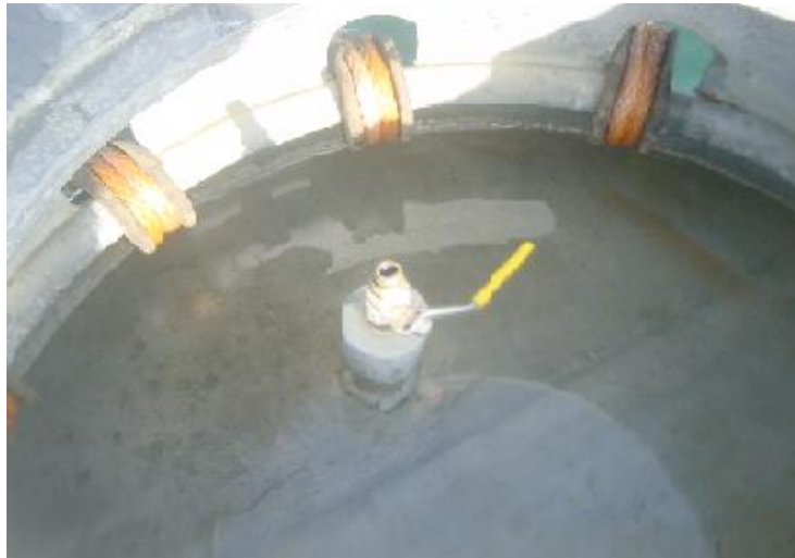
Figura 16: Válvula de ar existente na extremidade superior do tubo central da jaula Sea Station 3000® (Fonte: IPIMAR, Pousão-Ferreira)
