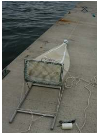
Figura 1 – Rede passiva de plâncton utilizada na amostragem (Foto cedida por Henrique Queiroga).
