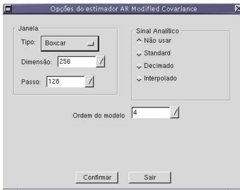
Figura 6.20: Definição das opções de execução do estimador AR-MC.
