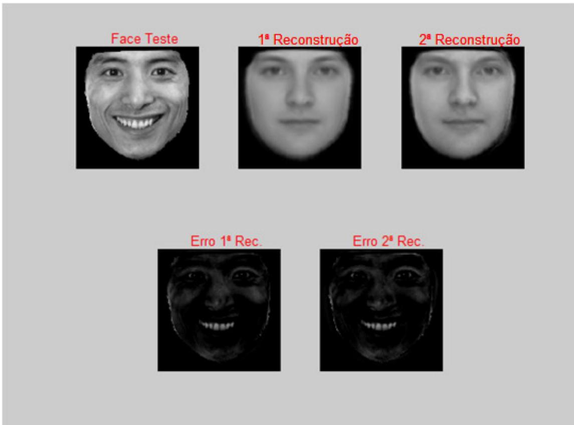
Fig. 4.15 – Reconstruções de uma face que não pertence ao conjunto de treino e não está normalizada (utilizando 10 e 20 faces próprias) e respectivos erros
