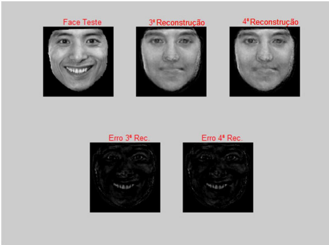
Fig. 4.16 – Reconstruções de uma face que não pertence ao conjunto de treino e não está normalizada (utilizando 100 e 150 faces próprias) e respectivos erros
