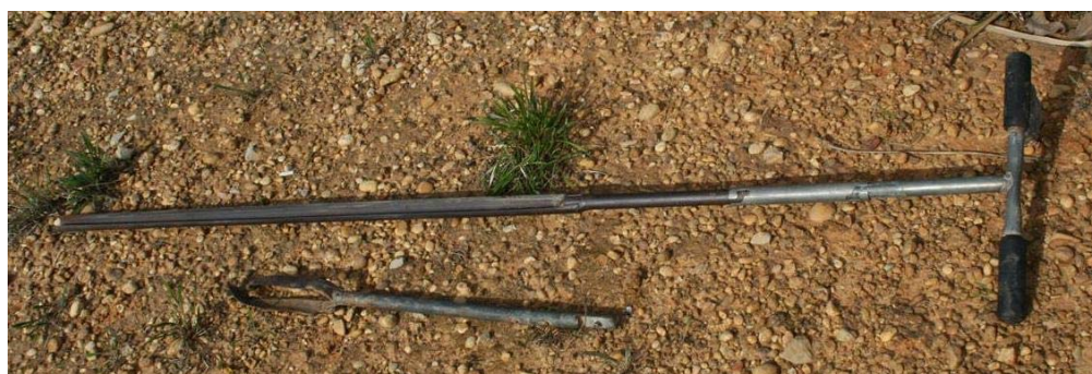
Figura 7.2 Sonda manual de meia cana (FCMA, Universidade do Algarve).
