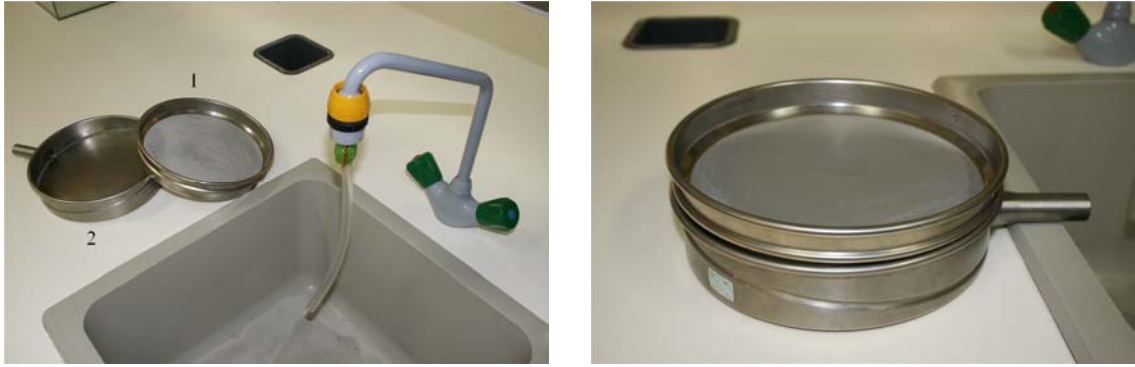
Figura 7.6 a) Material utilizado na lavagem da amostra (FCMA – Universidade do Algarve): 1. Crivo de inox de 63 \mu\text{m} ; 2. Colector de suspensão munido de um tubo de escoamento; b) Crivo e colector em coluna.
