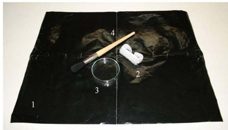
Figura 7.10 Material utilizado na fase de pesagem das fracções granulométricas obtidas no processo de peneiração na FCMA (Universidade do Algarve):
