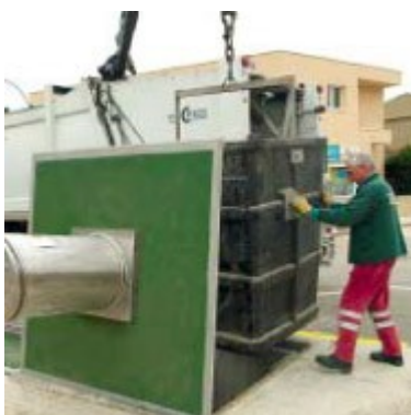
Figura 8 – Procedimento de recolha dos contentores subterrâneos (Fonte: Sotkon Portugal).
