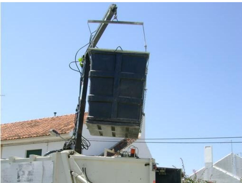
Figura 11 – Exemplo de recolha de um contentor subterrâneo pela viatura de recolha com grua (Fonte: SOMA S.A.).
