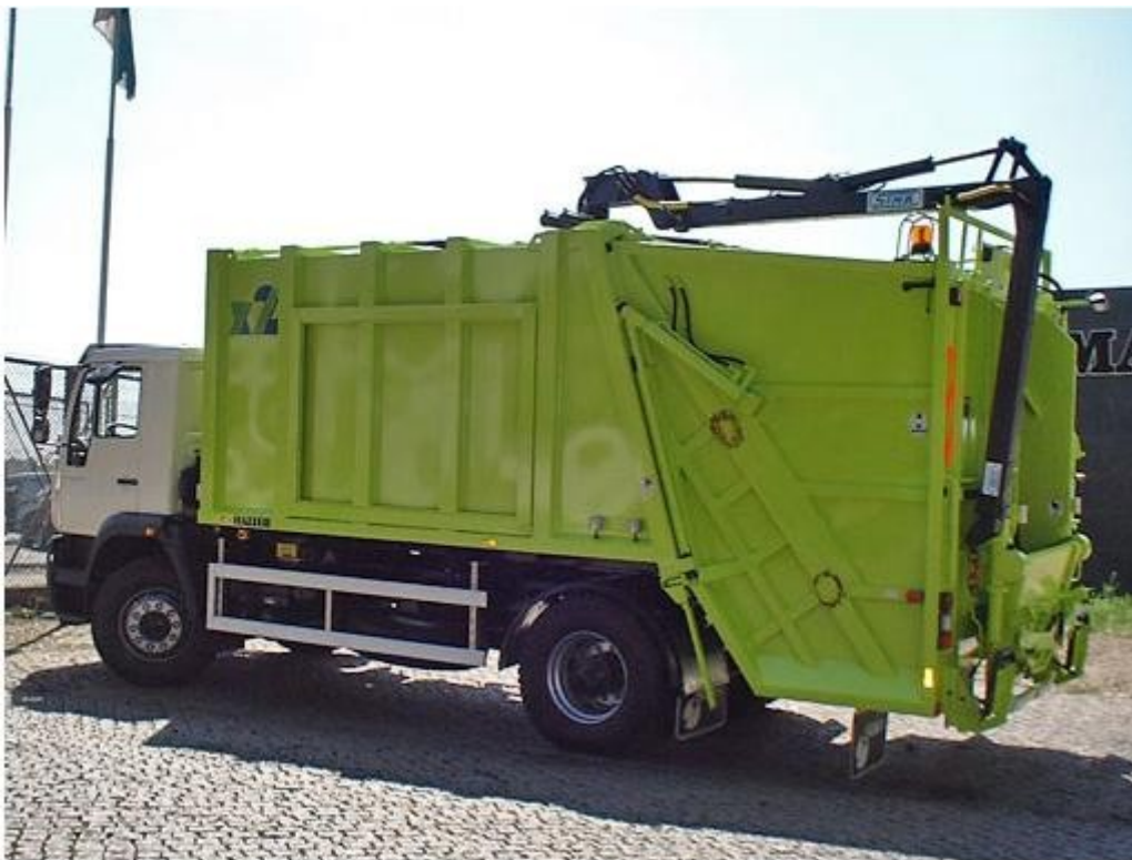
Figura 10 – Exemplo de uma viatura de recolha de RU indiferenciados com grua (Fonte: SOMA S.A.).
