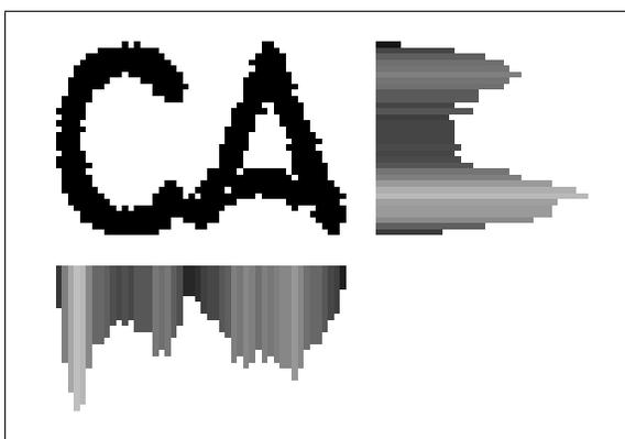
Figura 5.11: Esta figura apresenta o histograma vertical e horizontal dos caracteres conexos 'CA'. A análise é feita em ambos os eixos de modo a encontrar as linha potenciais de segmentação. Este procedimento é apenas aplicável nos casos em que os elementos apresentam na zona de conexão uma fraca densidade de pixels.
