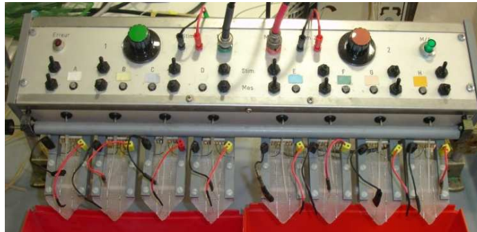
Figura 5: Imagem do aparelho estímulo-registo de prismas de Torpedo marmorata .
