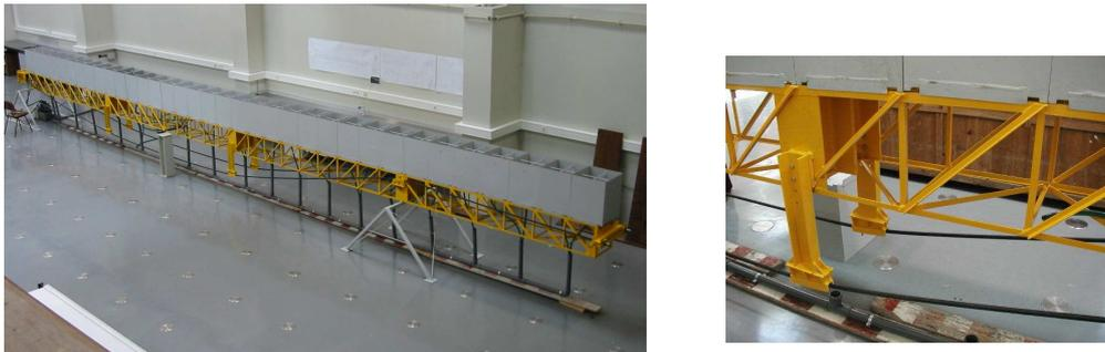
Figura 1: Modelo laboratorial com simulador de carga (“caixas” para enchimento com água)
