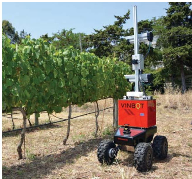
Figura 2 – Protótipo do robô VINBOT (Proj. VINBOT, FP7, Grant Agreement n.º 605630) em funcionamento numa sessão de demonstração nas vinhas do Instituto Superior de Agronomia em Lisboa
