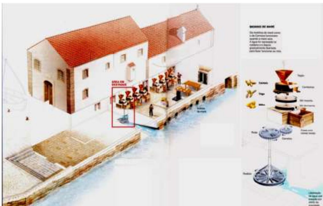
Imagem 16: Funcionamento de um Moinho de Maré Fonte: http://alvarovelho.net/index.php/agrupamento/contextos/234agrup/contextos/39-patrono?showall=1&limitstart=&hitcount=0#moinhos-maré
