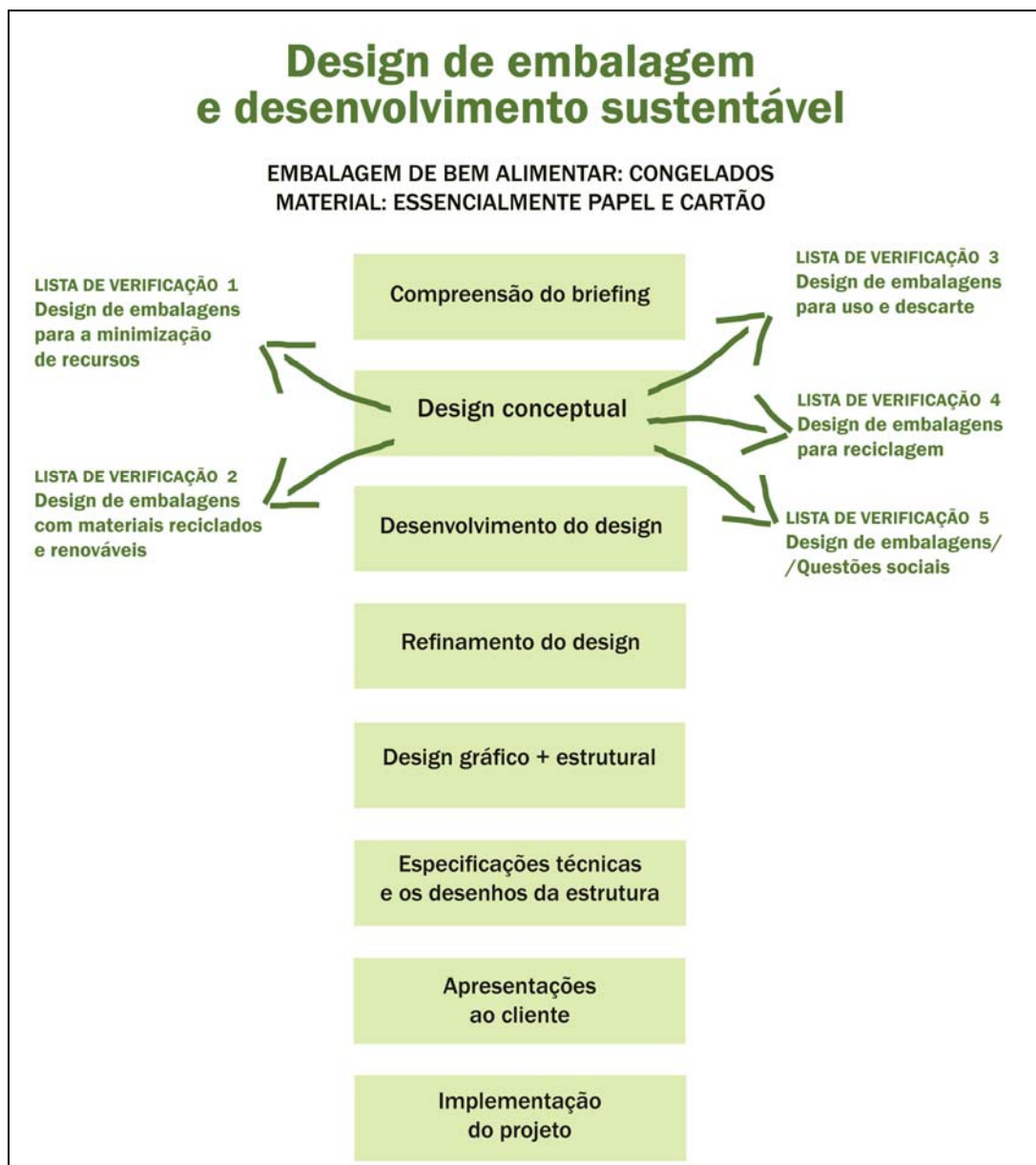
Figura 67. Aperfeiçoamento do Modelo Metodológico para o design de embalagem de bens alimentares, considerando os parâmetros de sustentabilidade.
