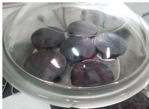
Figura 4.11 Recipientes no exsicador (ensaio de permeabilidade)
