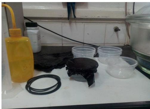
Figura 4.10 Preparação do ensaio de permeabilidade
