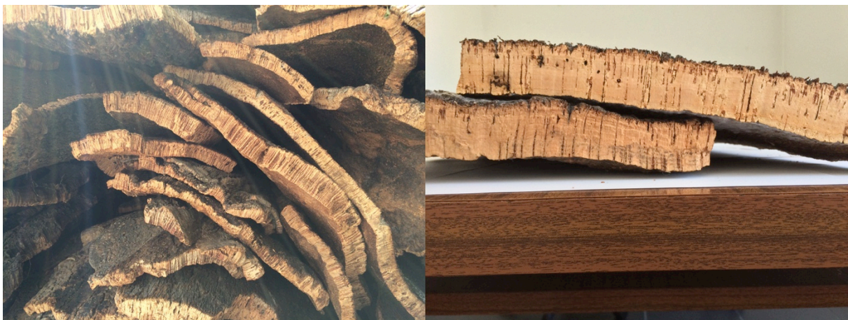
Figura 12 – Pranchas de cortiça. À esquerda pode-se observar pranchas de cortiça amadia sem qualquer tipo de traçamento ainda, denota-se que a superfície é bastante irregular. À direita encontra-se cortiça já traçada. Comparando as duas imagens, é possível perceber que a cortiça traçada já apresenta uma superfície regularizada podendo ser utilizada posteriormente na etapa de brocagem, dando origem às rolhas
