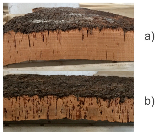
Figura 13 – Qualidade da cortiça. a) Cortiça de boa qualidade, correspondendo a 1ª; b) Cortiça de fraca qualidade (5ª)
