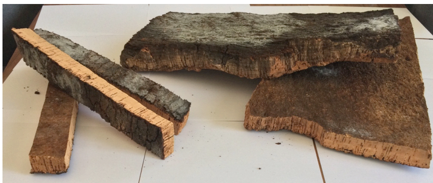
Figura 16 - Tiras de rabaneação prontas para a entrada na broca (esquerda) e cortiça traçada pronta a ser rabaneada para dar origem a tiras (direita)
