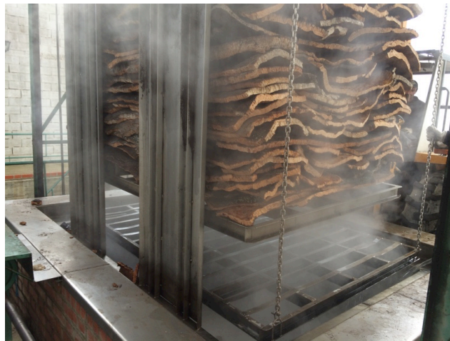
Figura 15 - Paleta de cortiça à saída da etapa de 2ª cozedura
