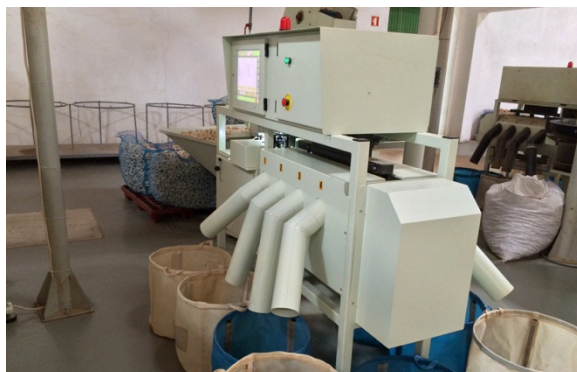
Figura 21 - Equipamento utilizado na 2ª escolha eletrónica. Cada rolha é analisada individualmente e em seguida é lhe atribuída uma classe. A capacidade de escolha do equipamento permite escolher até cerca de 10 000 rolhas por hora.
