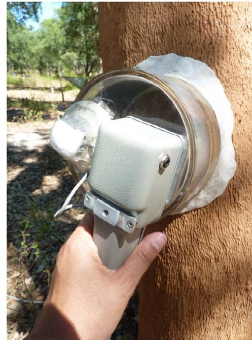
**Equipamento: Analisador de gases infra-vermelho (IRGA LCPro+ ) com uma câmara de solo adaptada (medições: 10h e 15h)**
