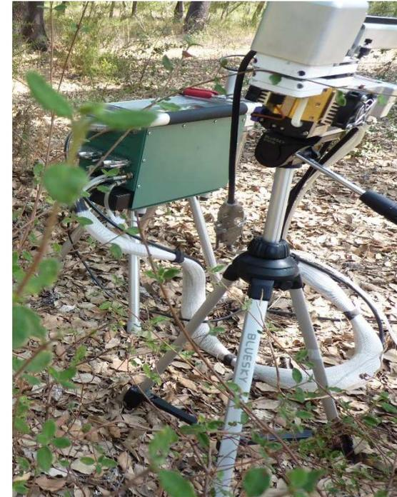
**Equipamento: Analisador de gases infra-vermelho (IRGA Li840a e IRGA 6400) com câmara escura e clara (medições: 10h e 15h)**
