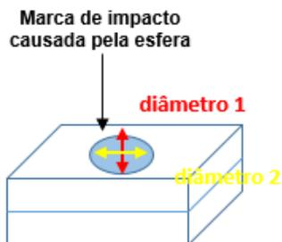
Figura 16. Esquema das medições dos diâmetros realizados à marca de impacto
