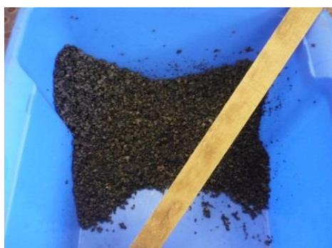
Figura 18. Mistura de regranulado negro com cola
