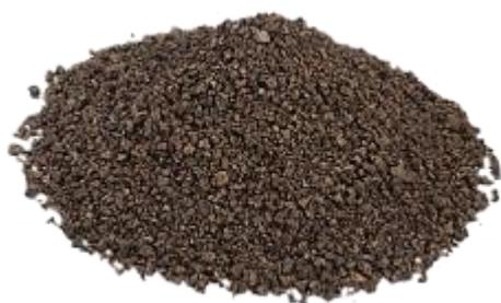
Figura 7. Regranulado negro de cortiça expandida (ISOCOR)
