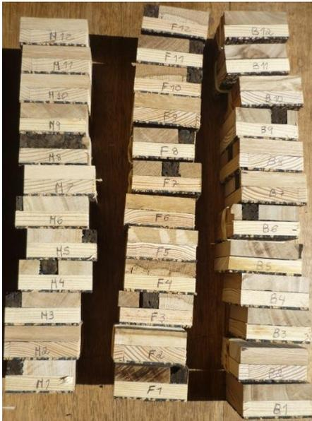
Figura 14. Provetes 5x5 cm de protótipo de *E. maculata* (M), protótipo de *Q. faginea* (F) e *E. botryoides* (B)
