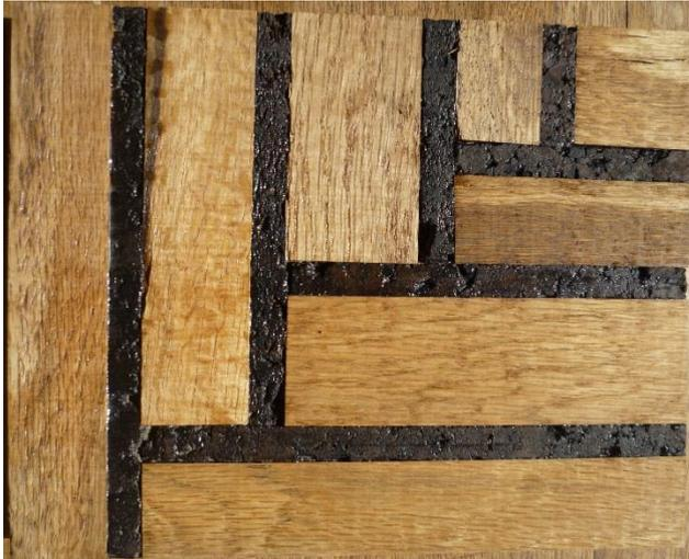
Figura 36. Madeira de *Q. faginea* e aglomerado expandido de cortiça com um acabamento de verniz
