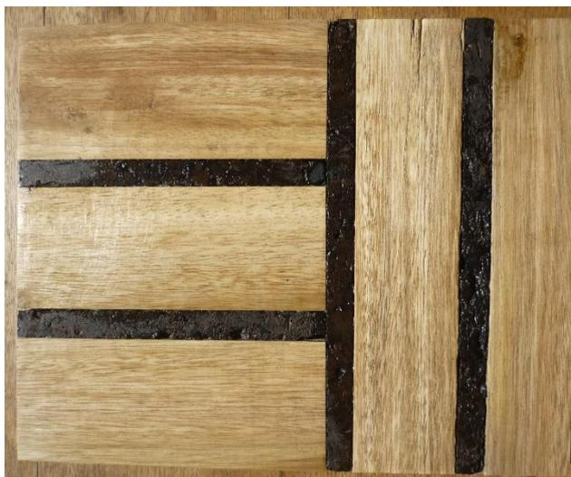
Figura 35. Madeira de *E. maculata* e aglomerado expandido de cortiça com um acabamento de verniz
