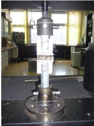
Figura 27. Ensaio de tração na máquina INSTRON 4467.
