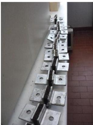
Figura 26. Suportes metálicos com provetes para realização dos ensaios à tração.
