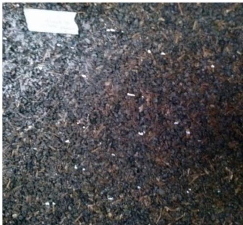
Figura 46. Placa de regranulado negro com cola e aparas de *Q. Faginea*
