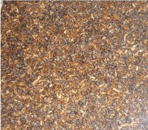
Figura 44. Placa de regranulado negro com cola e cascas de *E. botryoides*
