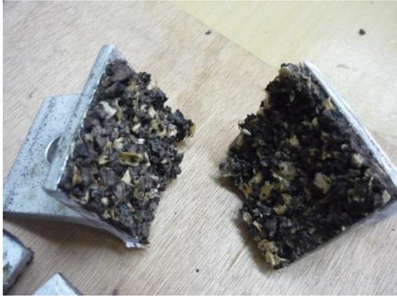
Figura 52. Resultado do ensaio 13, realizado a amostra de regranulado negro com cola e aparas de *E. maculata*
