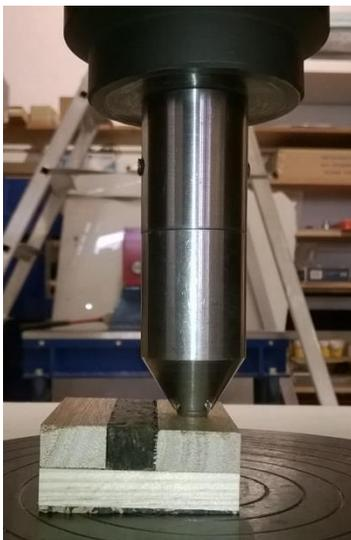
Figura 15. Ensaio de dureza Brinell a um provete constituído por madeira de *E. botryoides*
