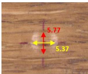
Figura 39. Diâmetros da moessa deixada pela esfera em madeira de *Q. faginea* (proвете F14)
