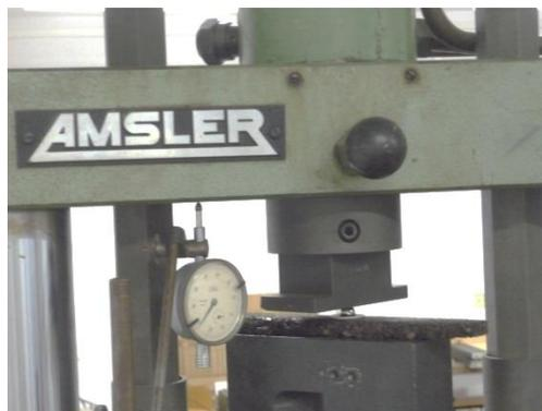
Figura 24. Ensaio de Dureza universal Amsler
