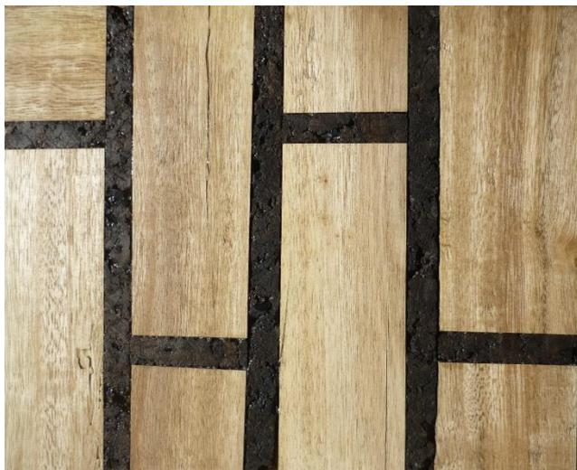
*Figura 33. Madeira de E. maculata e aglomerado expandido de cortiça com um acabamento de verniz*
