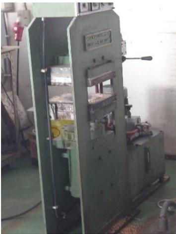
Figura 22. Prensa hidráulica de pratos quentes
