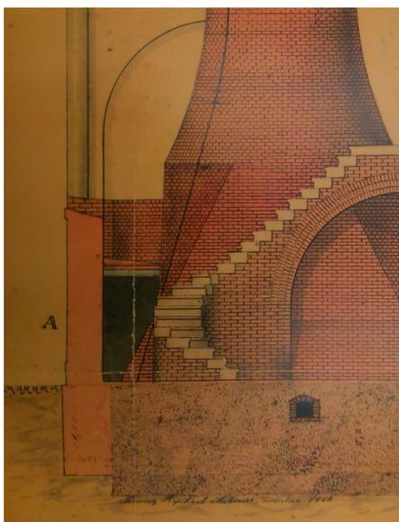
**Figura 90.** Corte **TRANSVERSAL** da Antiga Estação Elevatória da Praia, sem escala, 1867.
