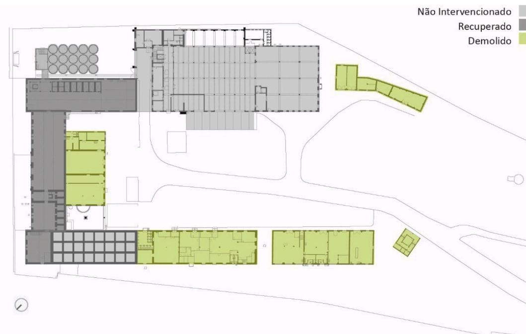
**Figura 72.** Planta esquemática da reconversão, edifícios demolidos e reabilitados. Imagem do autor com base em Inês Lobo Arquitectos.
