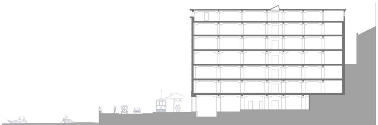
**Figura 115.** Corte **TRANSVERSAL** do Armazém Frigorífico de Bacalhau, sem escala. Carlos Prata, Gabinete de Arquitectura
